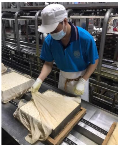
▲包布成型：手工包布時溫度高達 65°C
